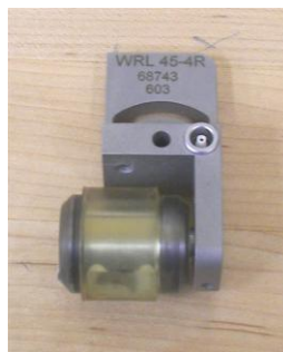
Figura 1. Transductor giratorio con acoplamiento en seco.
